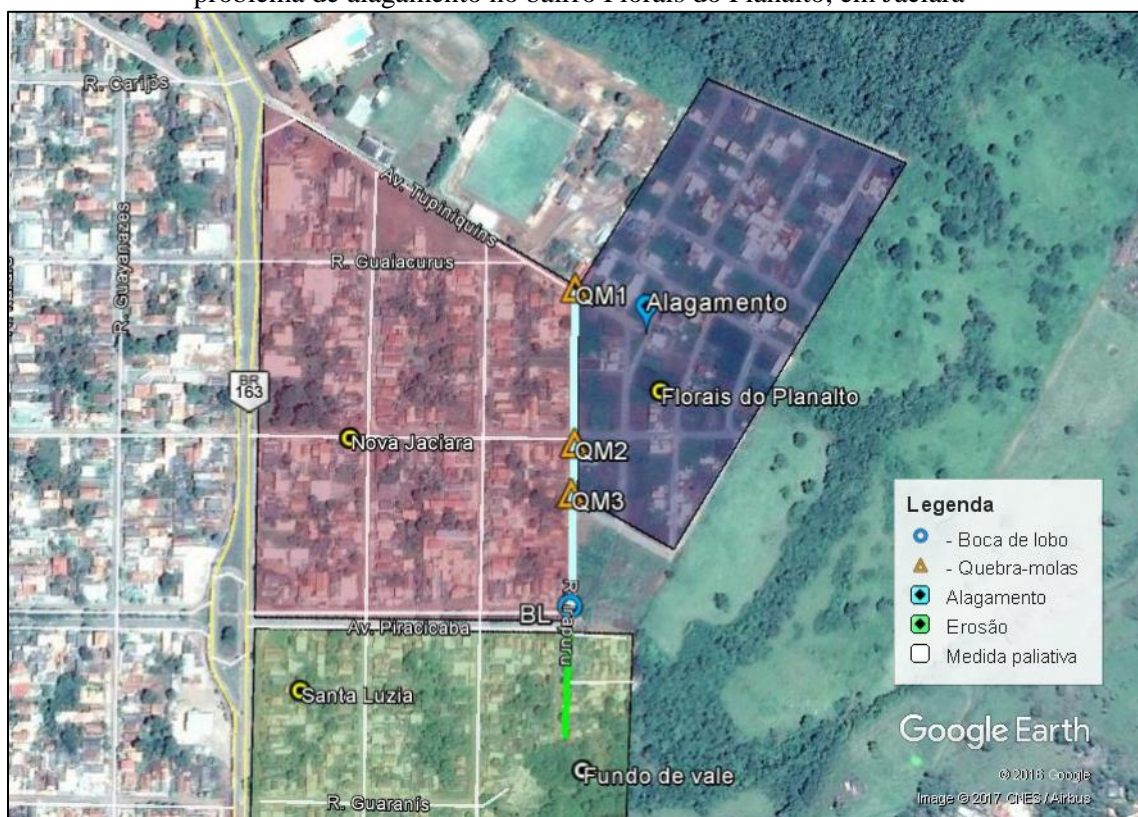
Figura 51. Localização dos dispositivos utilizados como medida paliativa para minimização do problema de alagamento no bairro Florais do Planalto, em Jaciara
