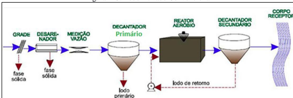
Figura 115. Lodo Ativado Convencional
