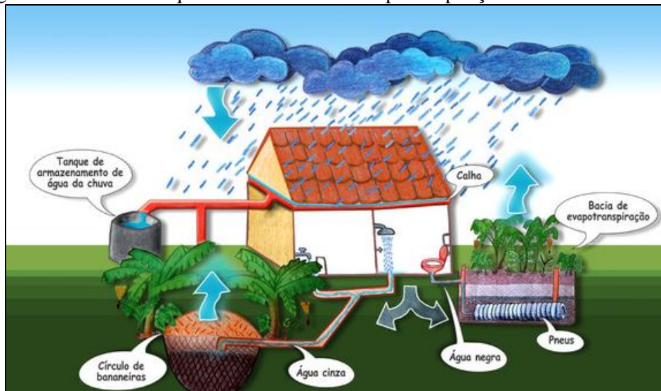
Figura 123. Desenho esquemático da bacia de evapotranspiração e círculo de bananeiras
