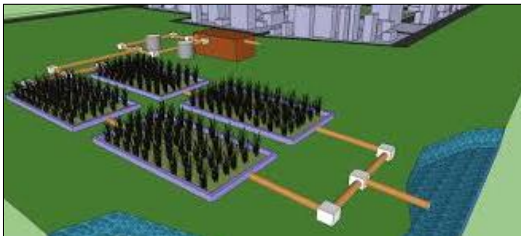
Figura 124. Sistema de tratamento individual utilizando zonas de raízes
