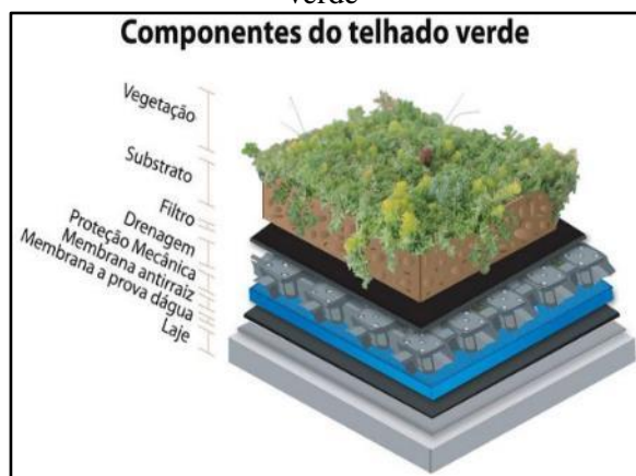
Figura 127. Esquema construtivo de telhado verde
