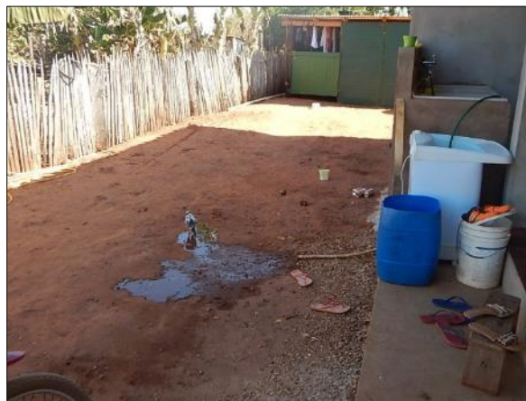
Figura 110. Disposição de efluente de pia e tanque a céu aberto, Catuaí, Juara-MT
