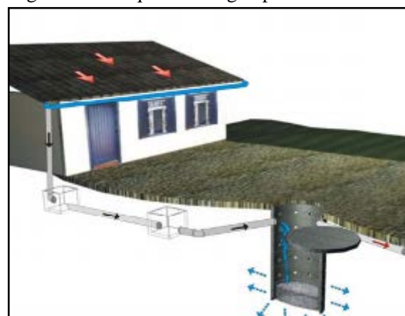
Figura 158. Esquema de água pluvial na fonte
