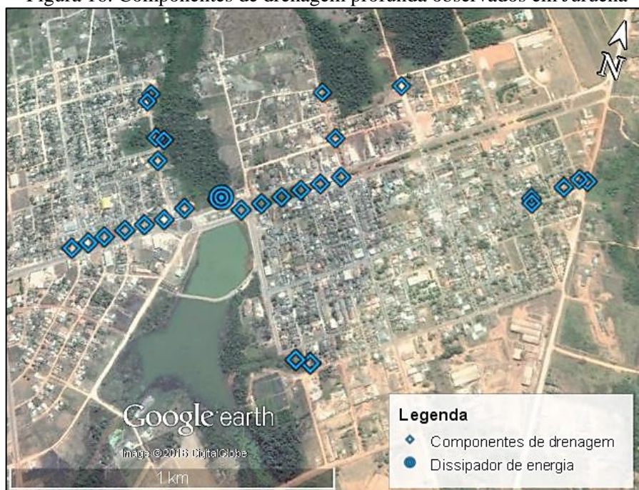
Figura 16. Componentes de drenagem profunda observados em Juruena
