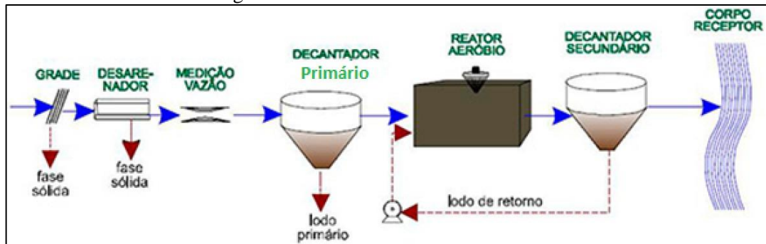
Figura 81. Lodos Ativados Convencional
