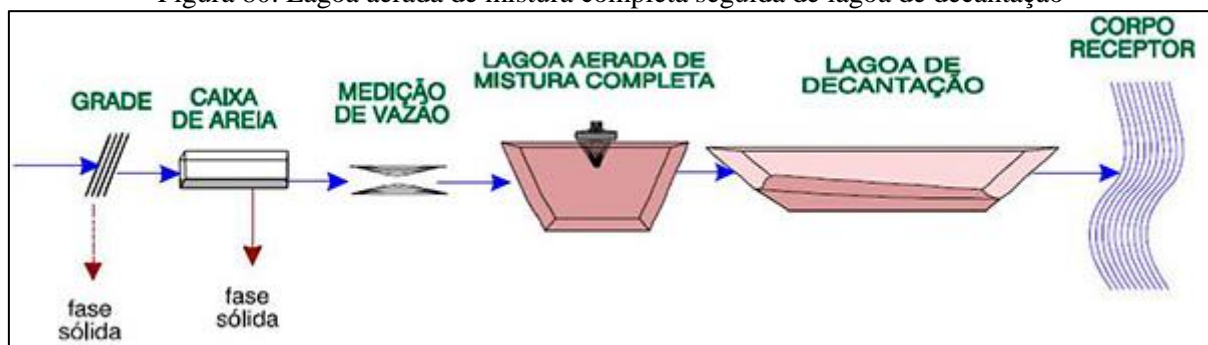
Figura 80. Lagoa aerada de mistura completa seguida de lagoa de decantação
