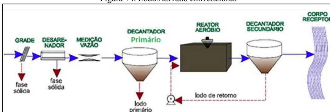
Figura 74. Lodos ativado convencional
