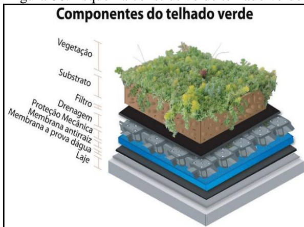
Figura 86. Esquema construtivo de telhado verde
