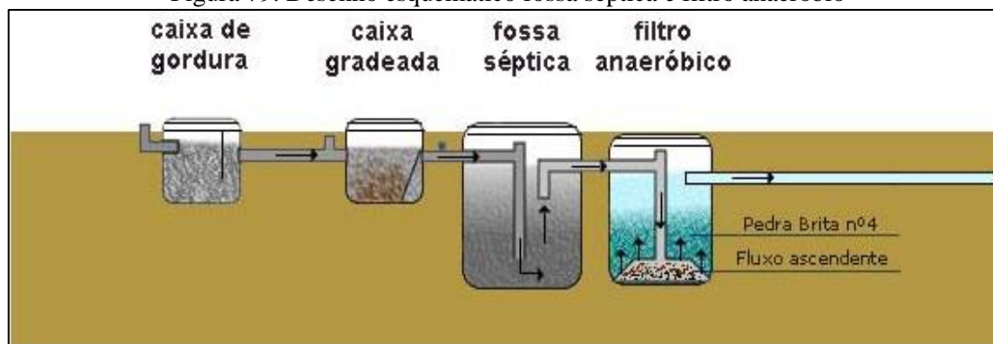
Figura 79. Desenho esquemático fossa séptica e filtro anaeróbio
