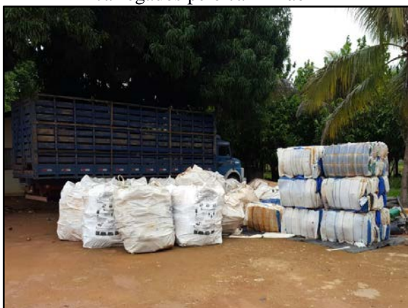
Figura 103. Bags com materiais plásticos ainda não compactados e fardos de plástico compactado segregados prontos para serem carregados pelo caminhão
