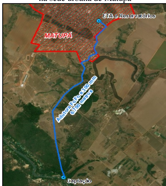
Figura 18. Caminhamento da adutora de água bruta na sede urbana de Matupá
