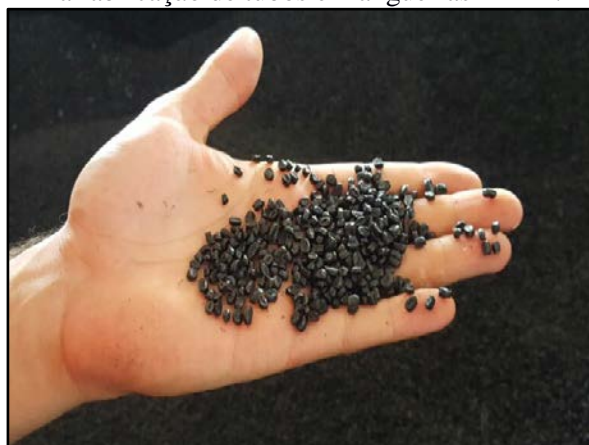
Figura 101. Material granulado provenientes do processamento de embalagens plásticas utilizado na fabricação de tubos e mangueiras PEAD.
