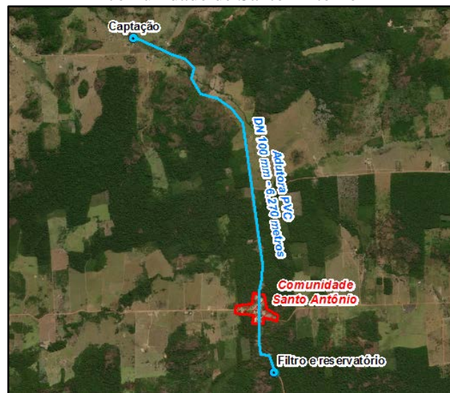
Figura 119. Caminhamento da adutora de água bruta na comunidade de Santo Antônio
