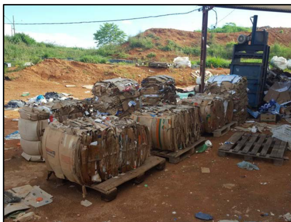
Figura 104. Fardos de papelão compactado e prensa utilizada para compactação
