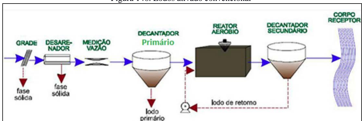
Figura 146. Lodos ativado convencional
