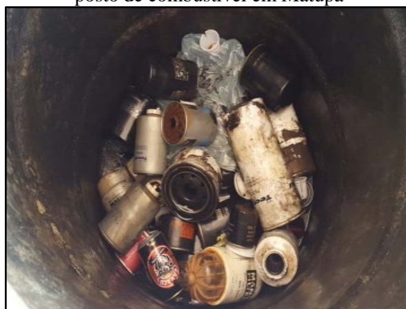
Figura 99. Resíduos contaminados com óleo lubrificante armazenados em um tambor em um posto de combustível em Matupá
