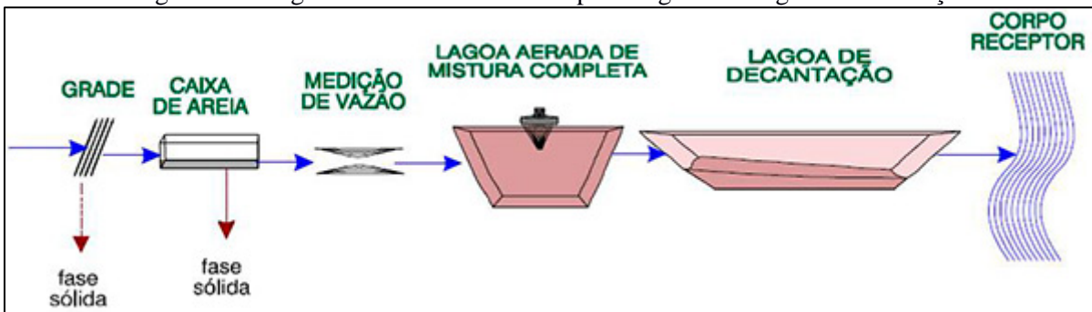
Figura 145. Lagoa aerada de mistura completa seguida de lagoa de decantação
