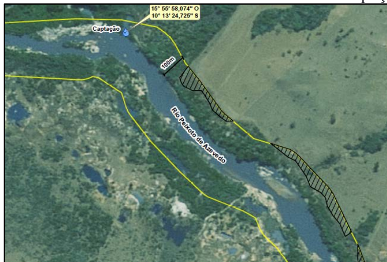
Figura 13. Mata ciliar desmatada (hachurada) na faixa de 100 metros da APP do Rio Peixoto de Azevedo à montante da captação
