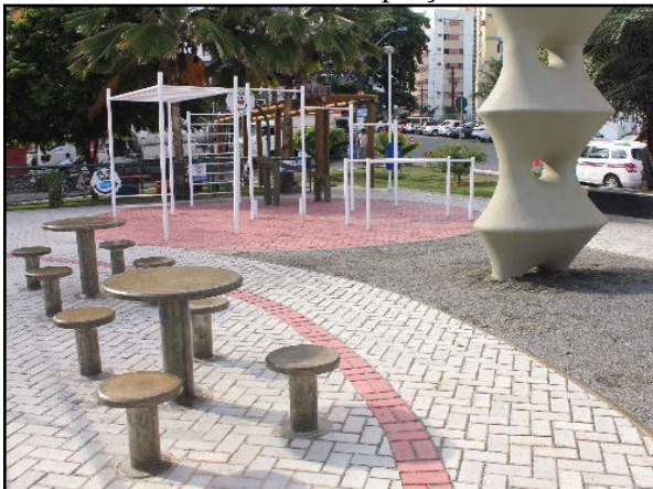
Figura 160. Pavimento poroso – piso intertravado instalado em praça
