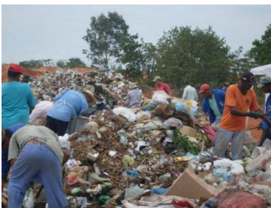
Figura 115 - Resíduos sólidos depositados sobre a lona e rompimento dos sacos para homogeneização (PGIRS, 2011).
