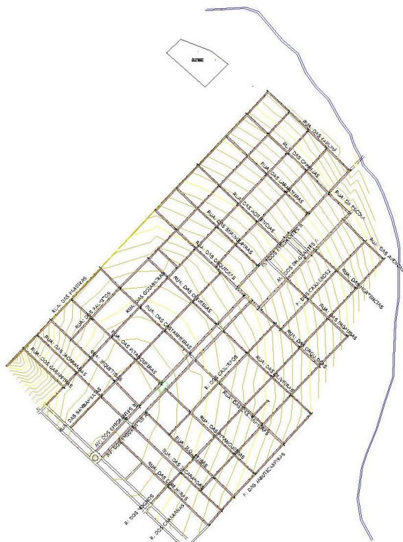
Figura 38: Levantamento topográfico realizado pela empresa contratada para a execução do projeto de esgoto.
