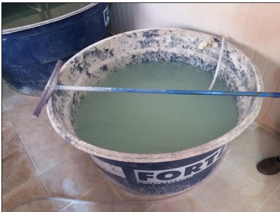
Figura 28: Caixa com solução de Hipoclorito de Cálcio pronta para ser misturada na água que já passou pelo processo de filtração.
