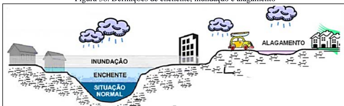
Figura 38. Definições de enchente, inundação e alagamento
