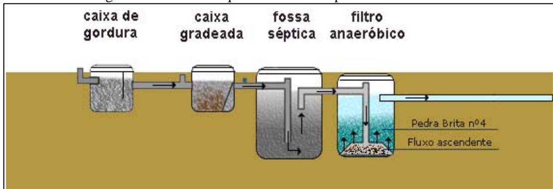
Figura 80. Desenho esquemático fossa séptica e filtro anaeróbico
