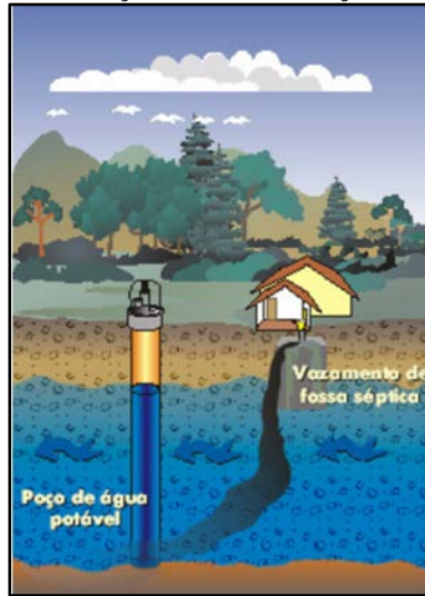
Figura 32. Modelo de contaminação do solo e lençol freático por extravasamento
