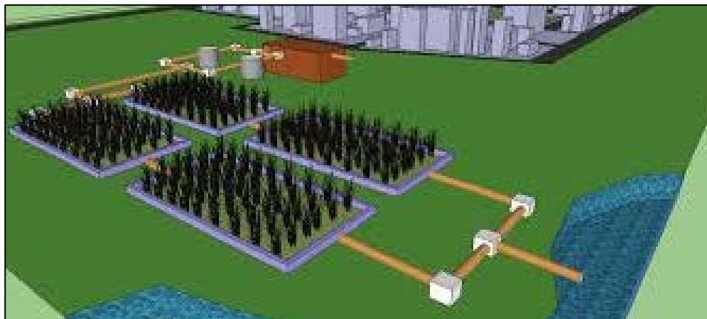
Figura 84. Sistema de tratamento individual utilizando zonas de raízes
