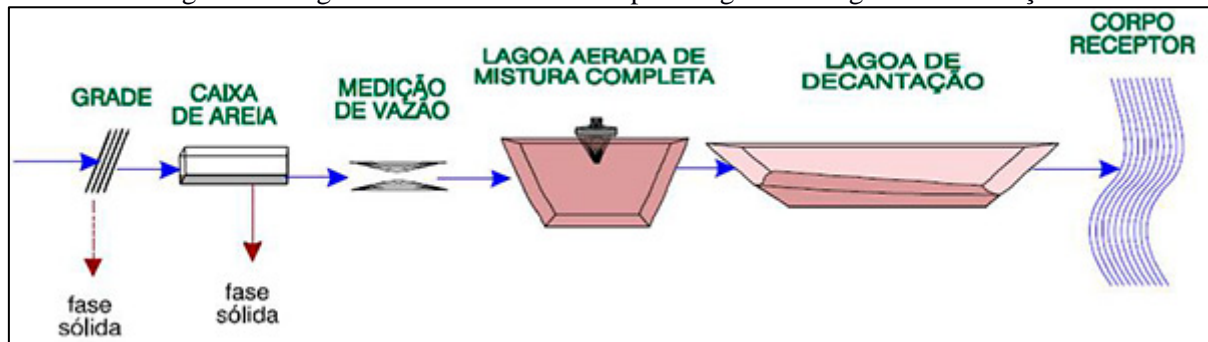
Figura 74. Lagoa aerada de mistura completa seguida de lagoa de decantação
