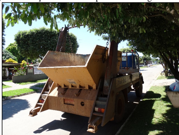
Figura 54. Caçamba metálica para armazenagem de RCD
