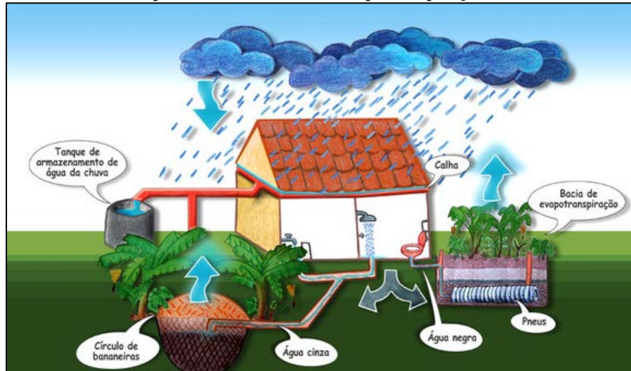
Figura 83. Desenho esquemático da bacia de evapotranspiração e círculo de bananeiras
