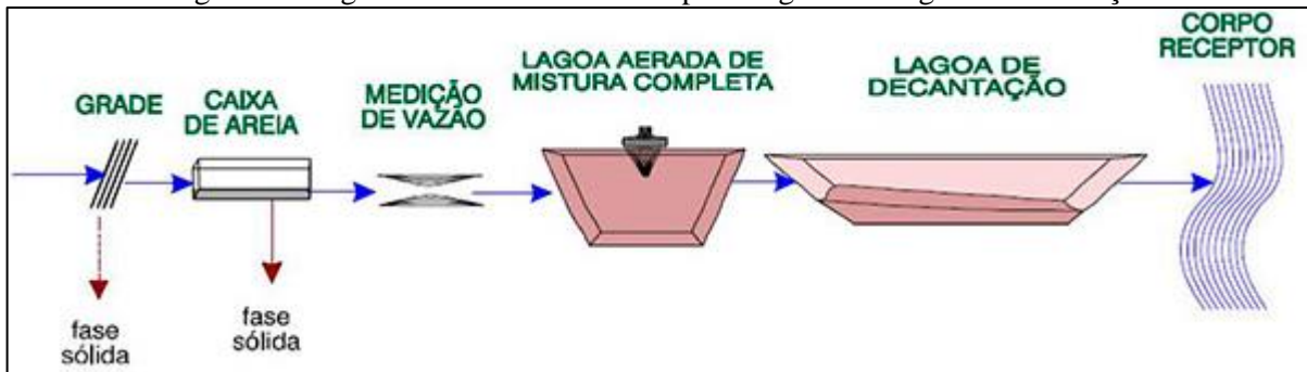
Figura 59. Lagoa aerada de mistura completa seguida de lagoa de decantação
