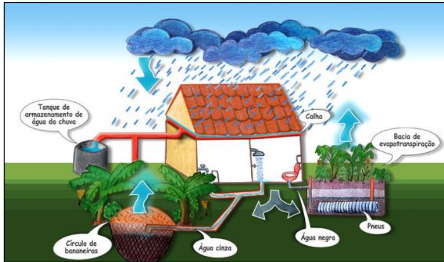
Figura 68. Desenho esquemático da bacia de evapotranspiração e círculo de bananeiras
