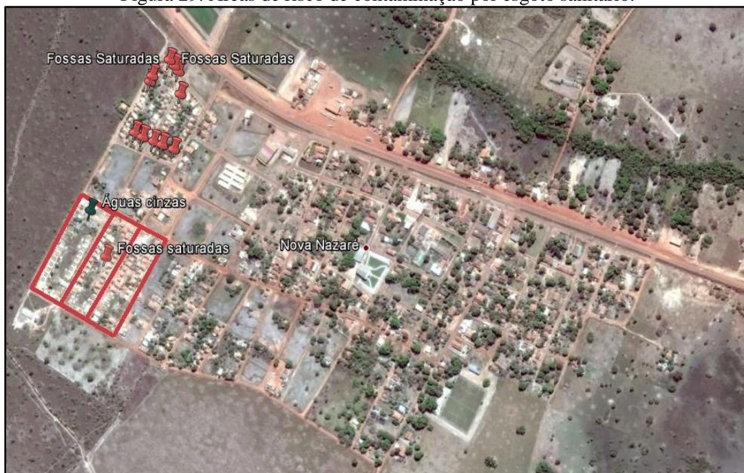
Figura 29. Áreas de risco de contaminação por esgoto sanitário.
