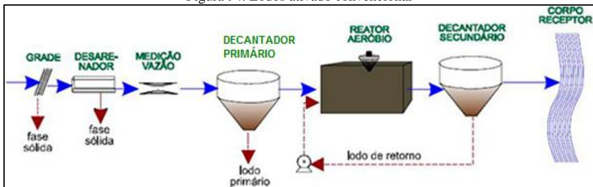
Figura 94. Lodos ativado convencional
