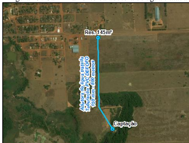
Figura 19. Caminhamento da adutora de água tratada
