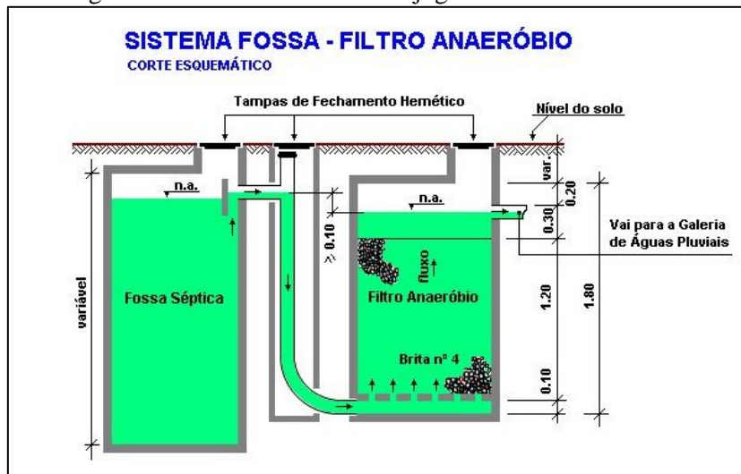
Figura 102. Sistema de fossa conjugada com filtro anaeróbio
