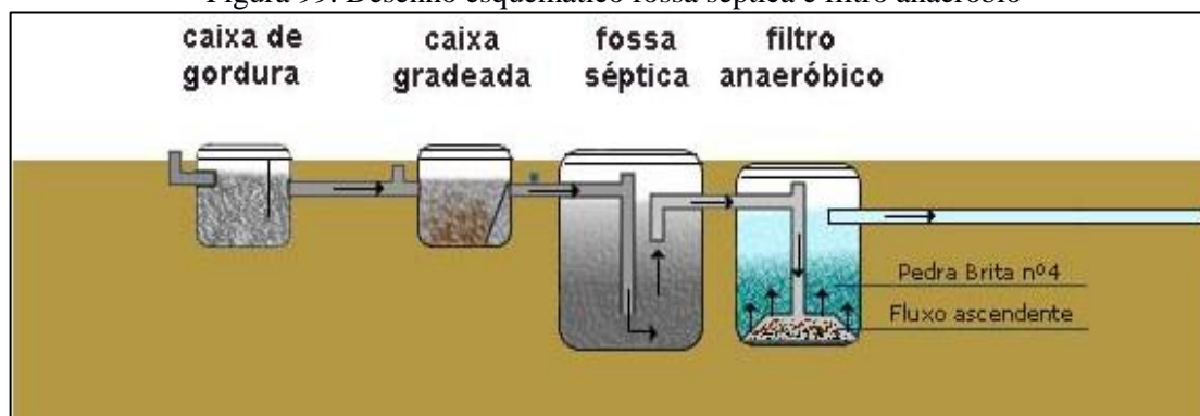
Figura 99. Desenho esquemático fossa séptica e filtro anaeróbio
