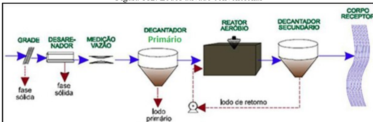
Figura 112. Lodos ativado convencional
