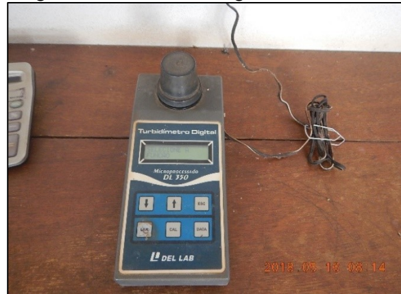
Figura 41. Turbidímetro digital no laboratório
