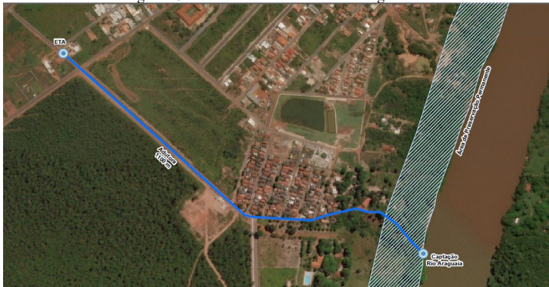
Figura 18. Caminhamento da adutora de água bruta
