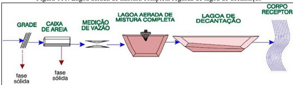
Figura 111. Lagoa aerada de mistura completa seguida de lagoa de decantação
