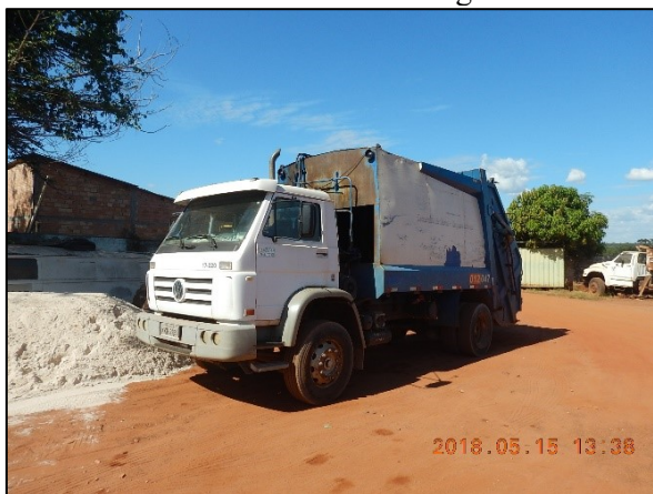
Figura 70. Caminhão compactador com capacidade para 8 m 3 utilizado na coleta de resíduos na cidade de Pontal do Araguaia
