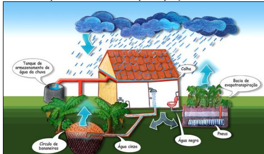
Figura 77. Desenho esquemático da bacia de evapotranspiração e círculo de bananeiras
