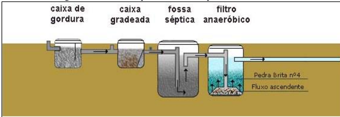
Figura 74. Desenho esquemático fossa séptica e filtro anaeróbio
