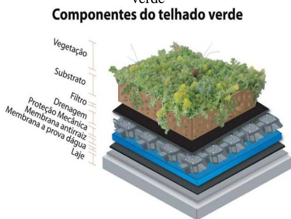
Figura 86. Esquema construtivo de telhado verde
