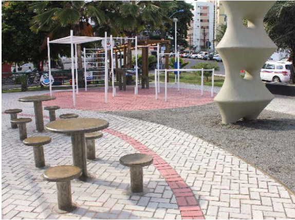
Figura 88. Pavimento poroso – piso intertravado instalado em praça
