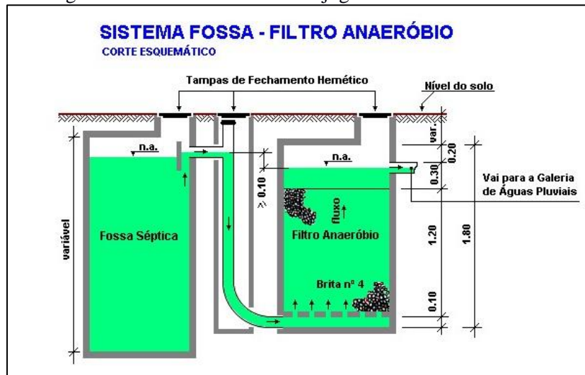
Figura 150. Sistema de fossa conjugada com filtro anaeróbio
