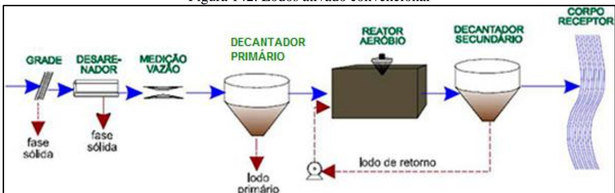
Figura 142. Lodos ativado convencional
