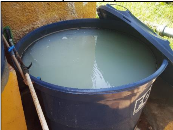
Figura 21. Preparo da solução de hipoclorito de cálcio em uma caixa d'água ao lado da casa de máquinas da captação
