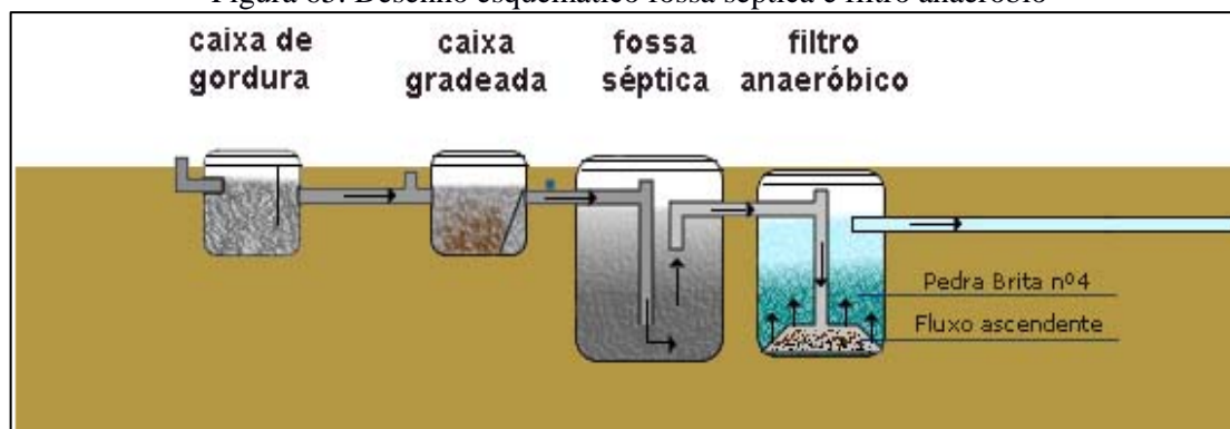
Figura 65. Desenho esquemático fossa séptica e filtro anaeróbio
