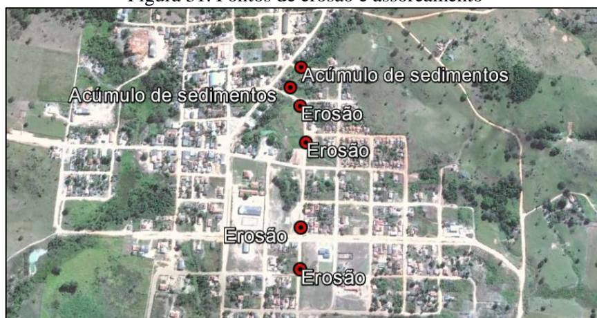
Figura 31. Pontos de erosão e assoreamento
