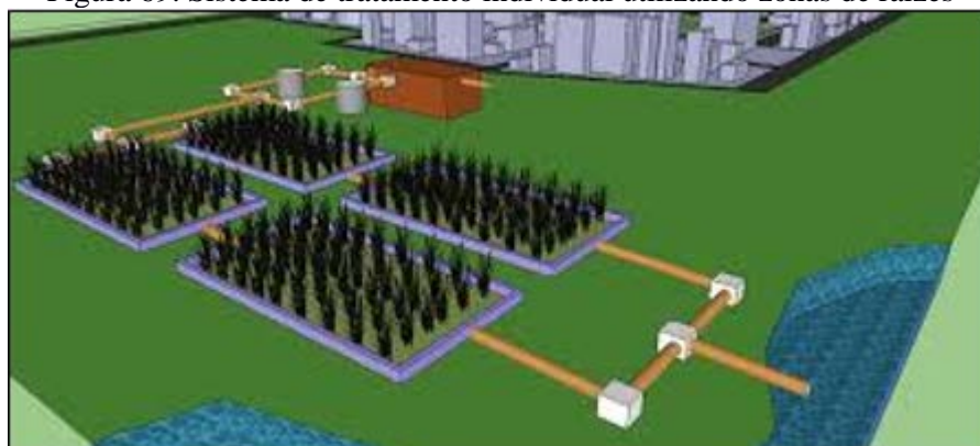
Figura 69. Sistema de tratamento individual utilizando zonas de raízes
