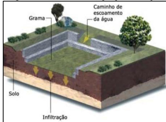
Figura 62. Reservatório em parque municipal
