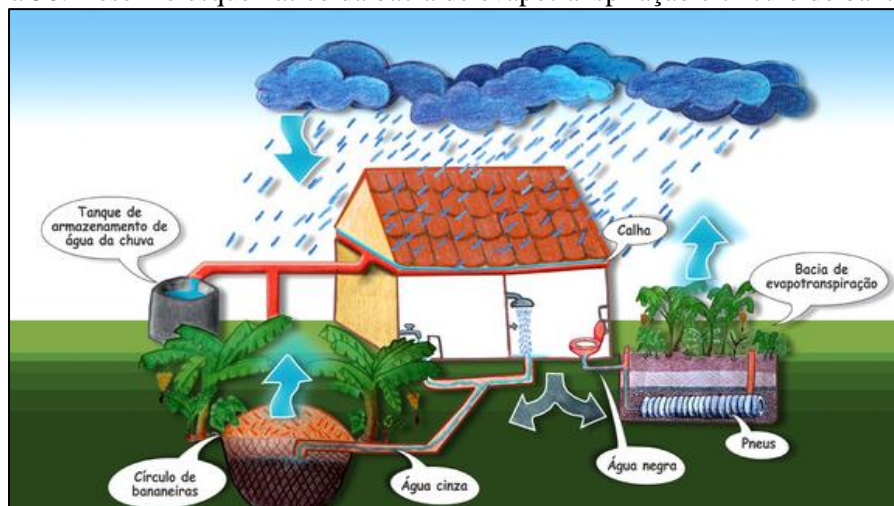
Figura 50. Desenho esquemático da bacia de evapotranspiração e círculo de bananeiras
