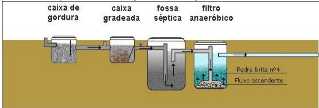
Figura 102. Desenho esquemático fossa séptica e filtro anaeróbio
