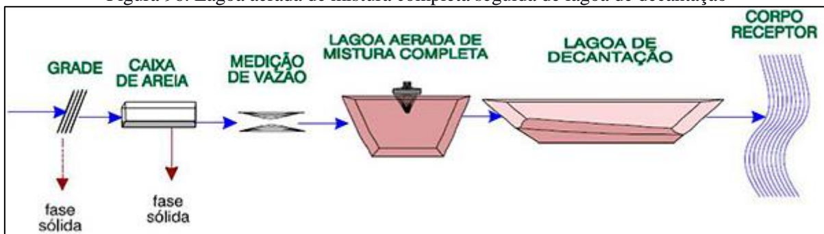
Figura 96. Lagoa aerada de mistura completa seguida de lagoa de decantação
