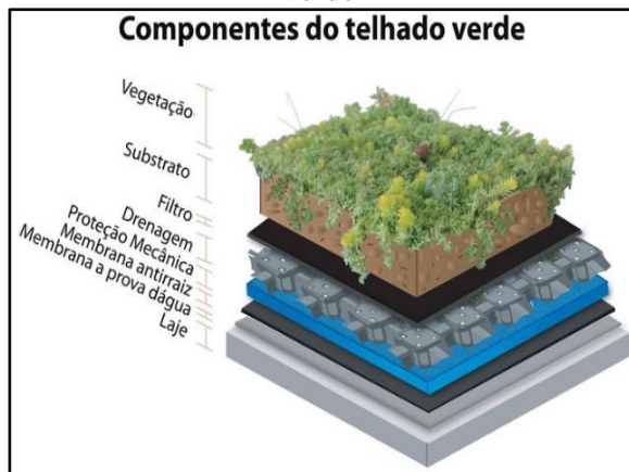
Figura 109. Esquema construtivo de telhado verde
