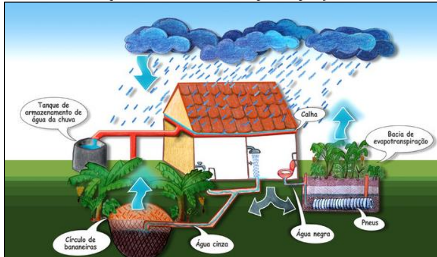
Figura 105. Desenho esquemático da bacia de evapotranspiração e círculo de bananeiras
