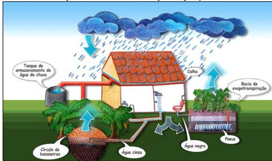
Figura 56. Desenho esquemático da bacia de evapotranspiração e círculo de bananeiras
