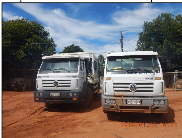
Figura 25. Caminhões compactadores de 18 e 12 m 3 utilizados para coleta dos resíduos sólidos
