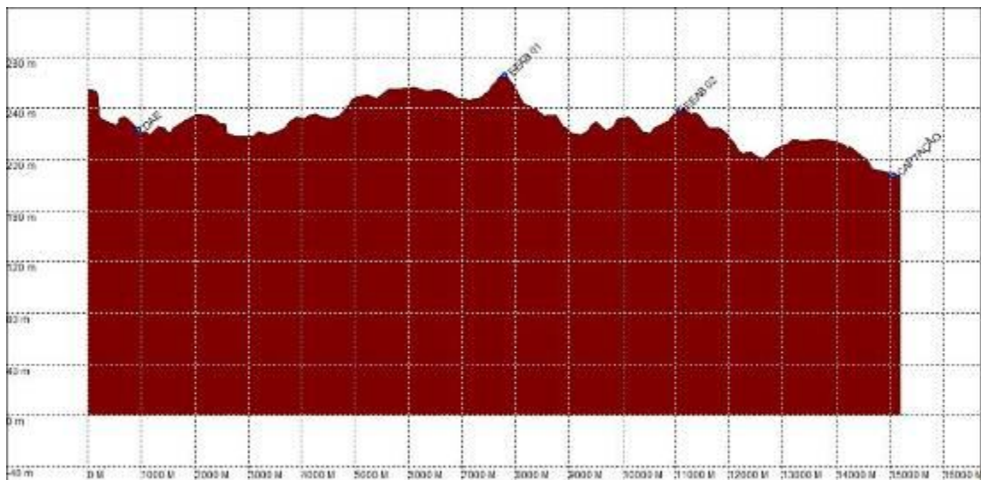
Figura 35 – Registro de elevação entre o DAE e a Captação.
