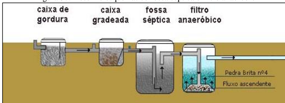
Figura 57. Desenho esquemático fossa séptica e filtro anaeróbio
