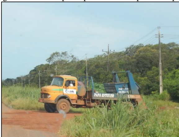
Figura 39. Caminhão poliguindaste de empresa privada usado para transporte de caçamba com RCC
