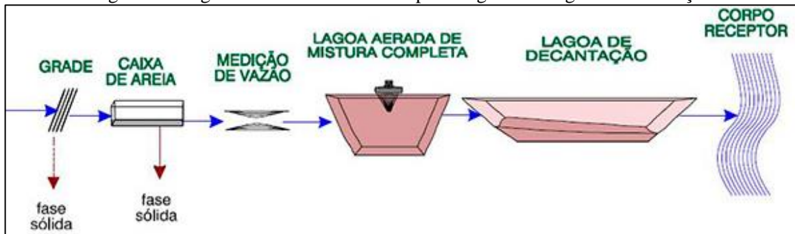
Figura 51. Lagoa aerada de mistura completa seguida de lagoa de decantação
