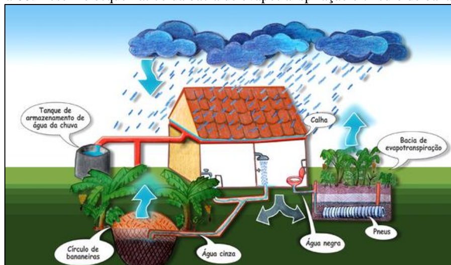
Figura 60. Desenho esquemático da bacia de evapotranspiração e círculo de bananeiras
