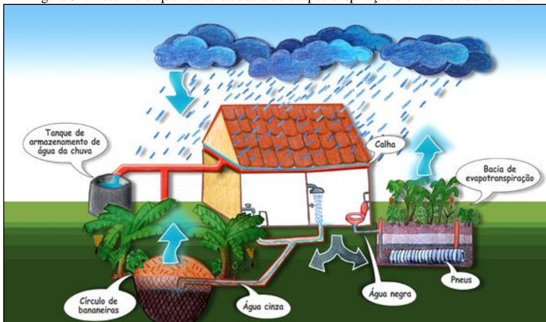
Figura 51. Desenho esquemático da bacia de evapotranspiração e círculo de bananeiras
