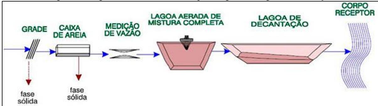
Figura 42. Lagoa aerada de mistura completa seguida de lagoa de decantação
