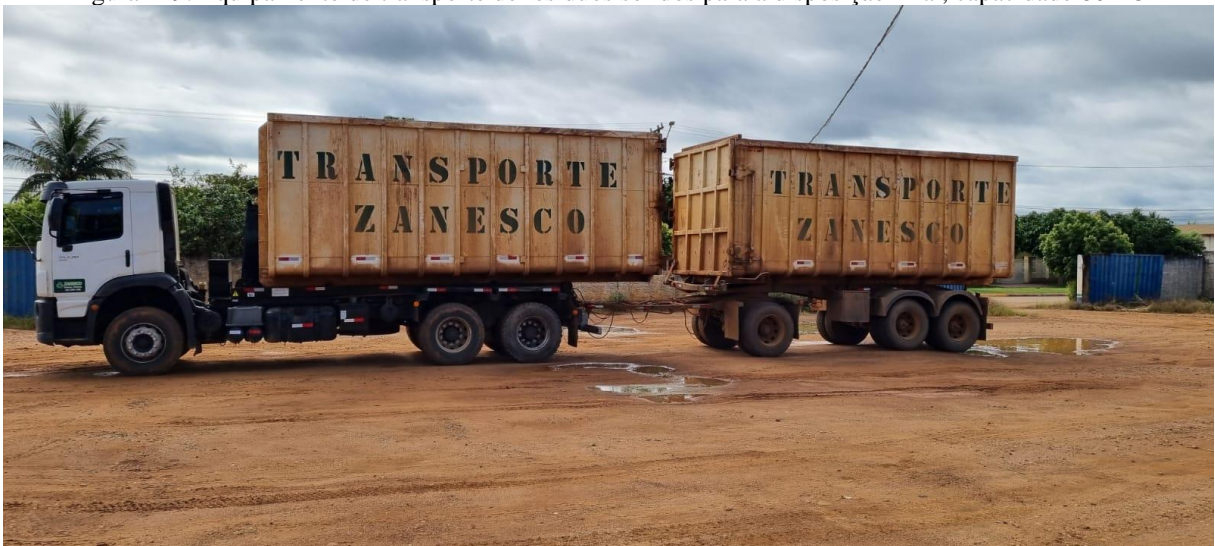
Figura 129. Equipamento de transporte de resíduos sólidos para a disposição final, capacidade 80 m 3
