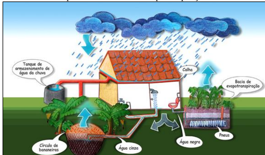
Figura 232. Desenho esquemático da bacia de evapotranspiração e círculo de bananeiras
