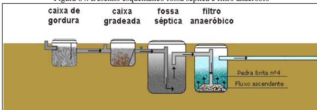
Figura 84. Desenho esquemático fossa séptica e filtro anaeróbio
