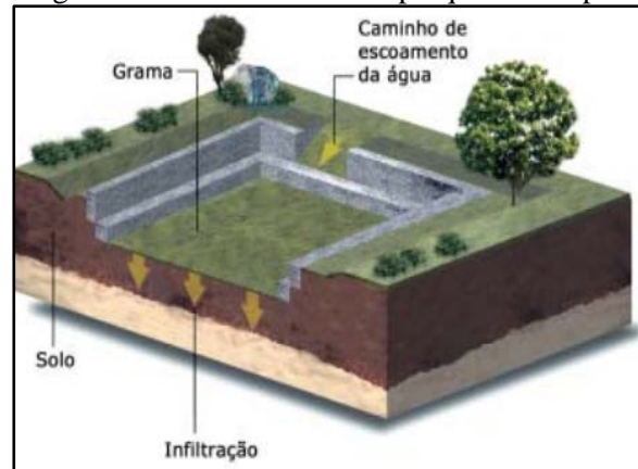
Figura 102. Reservatório em parque municipal
