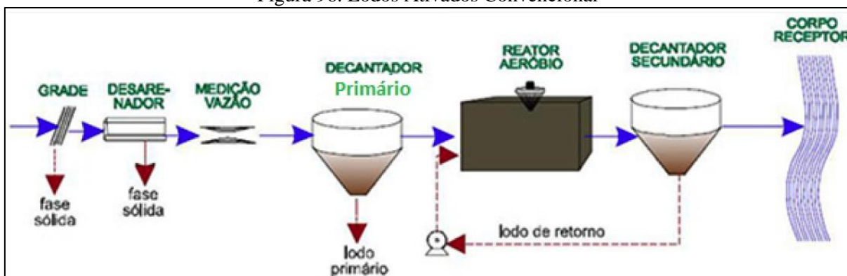
Figura 96. Lodos Ativados Convencional
