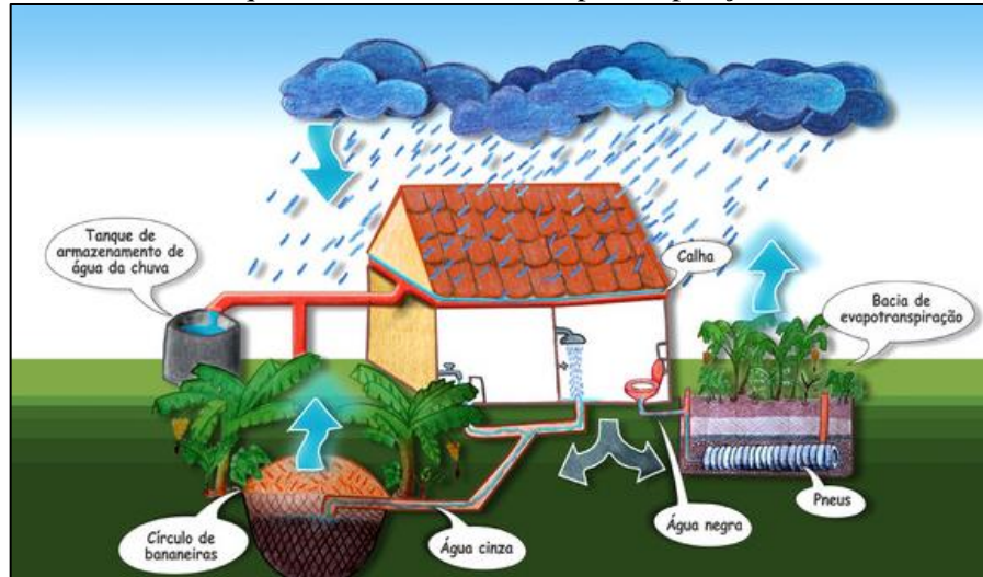
Figura 104. Desenho esquemático da bacia de evapotranspiração e círculo de bananeiras
