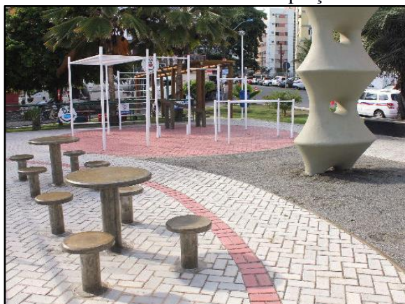
Figura 110. Pavimento poroso – piso intertravado instalado em praça
