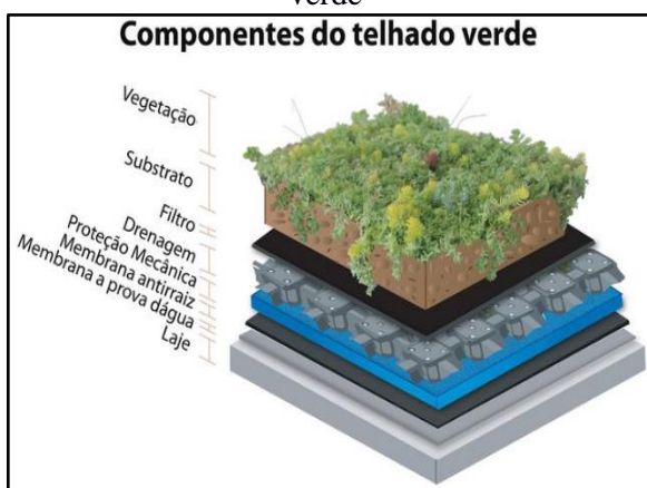
Figura 108. Esquema construtivo de telhado verde
