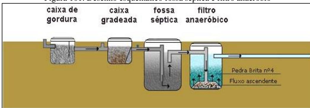
Figura 101. Desenho esquemático fossa séptica e filtro anaeróbio
