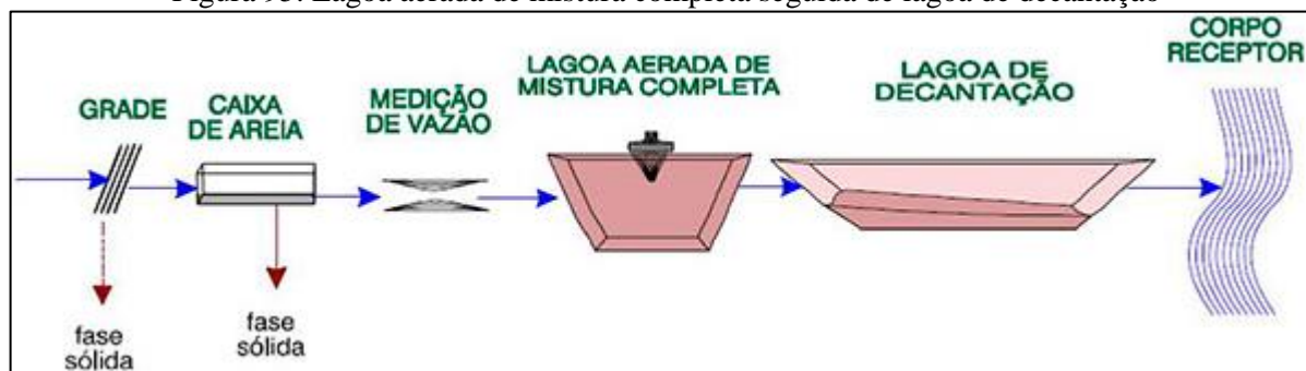
Figura 95. Lagoa aerada de mistura completa seguida de lagoa de decantação
