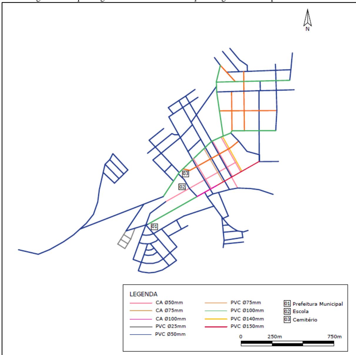
Figura 23. Esquema gráfico da rede de distribuição de água do município de Torixoréu
