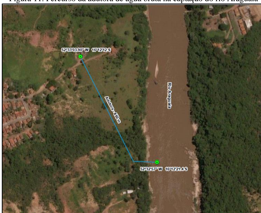
Figura 11. Percurso da adutora de água bruta na captação do rio Araguaia
