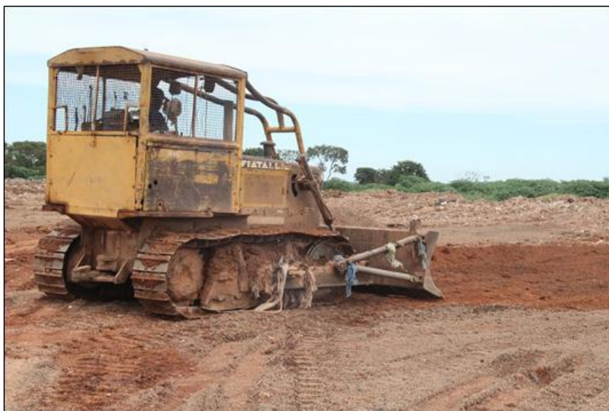
Figura 8 - Trator para Nivelamento dos Resíduos e para Lançamento de Terra
