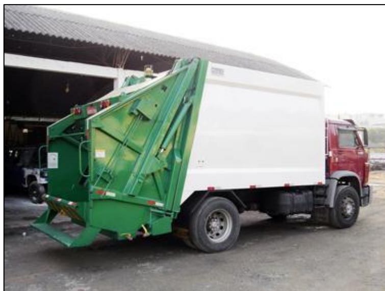
Figura 2 - Modelo de Caminhão Coletor-Compactador de 12 toneladas
