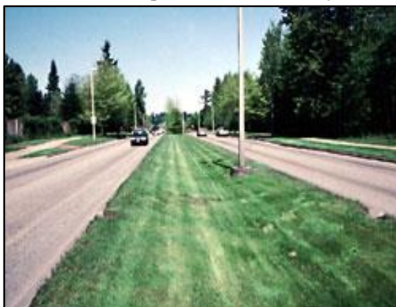
Figura 59 - Exemplo de vala de infiltração.
