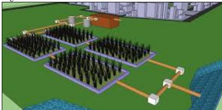
Figura 109. Sistema de tratamento individual utilizando zonas de raízes
