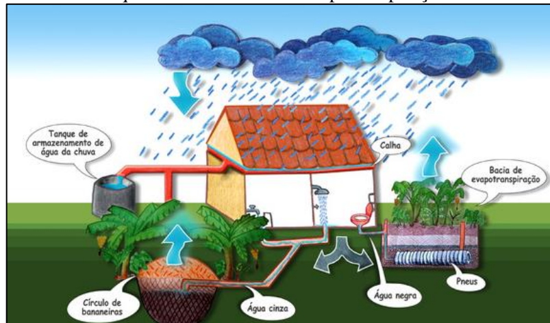
Figura 108. Desenho esquemático da bacia de evapotranspiração e círculo de bananeiras
