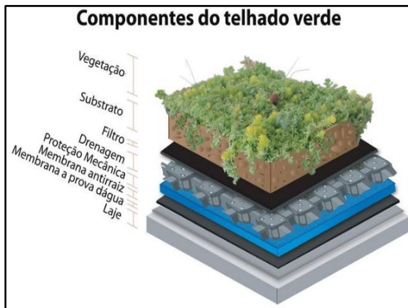
Figura 134. Esquema construtivo de telhado verde
