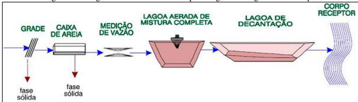
Figura 121. Lagoa aerada de mistura completa seguida de lagoa de decantação
