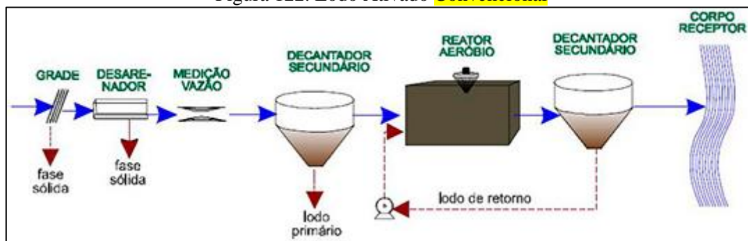
Figura 122. Lodo Ativado Convencional
