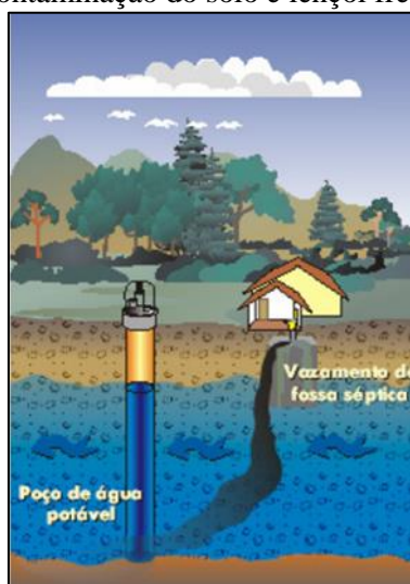
Figura 30. Modelo de contaminação do solo e lençol freático por extravasamento
