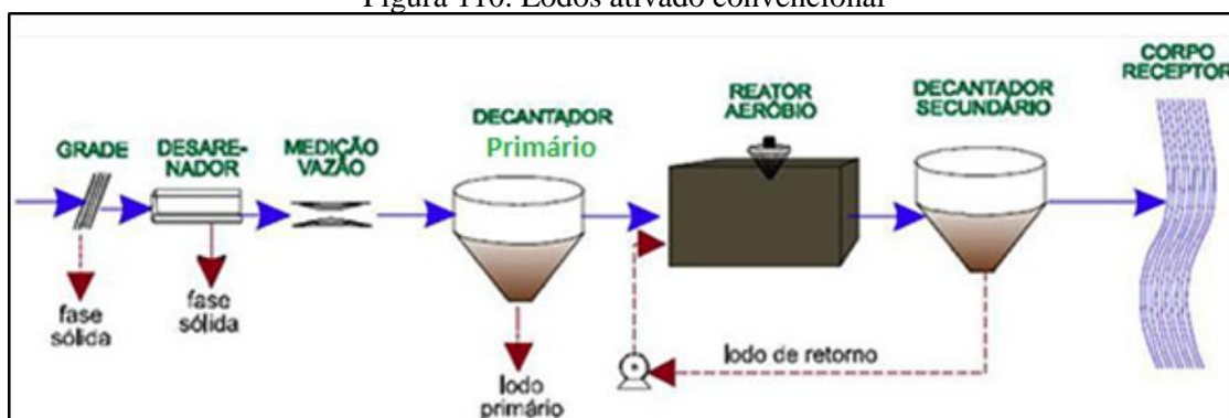
Figura 110. Lodos ativado convencional
