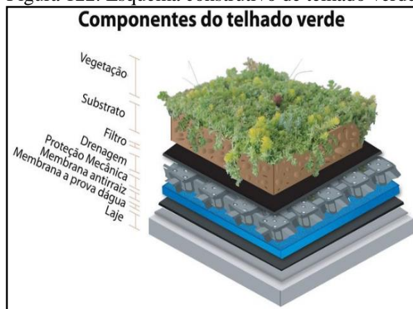
Figura 122. Esquema construtivo de telhado verde
