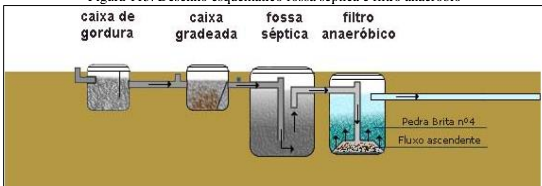
Figura 115. Desenho esquemático fossa séptica e filtro anaeróbico
