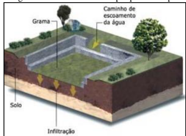
Figura 133. Reservatório em parque municipal
