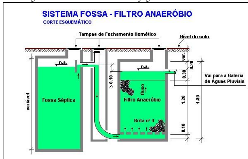
Figura 118. Sistema de fossa conjugada com filtro anaeróbio
