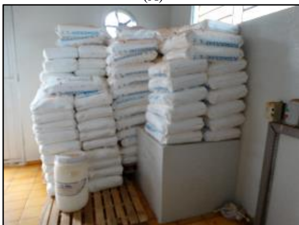
Figura 21. (A) Armazenamento dos produtos químicos em estrados de madeira e locais fechados e longe de ação de intempéries (B) Cloro utilizado na desinfecção da água
