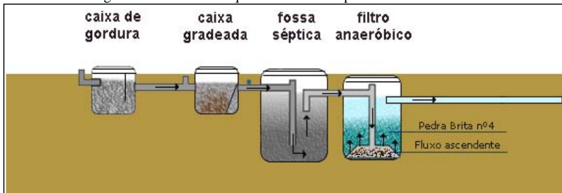
Figura 101. Desenho esquemático fossa séptica e filtro anaeróbico
