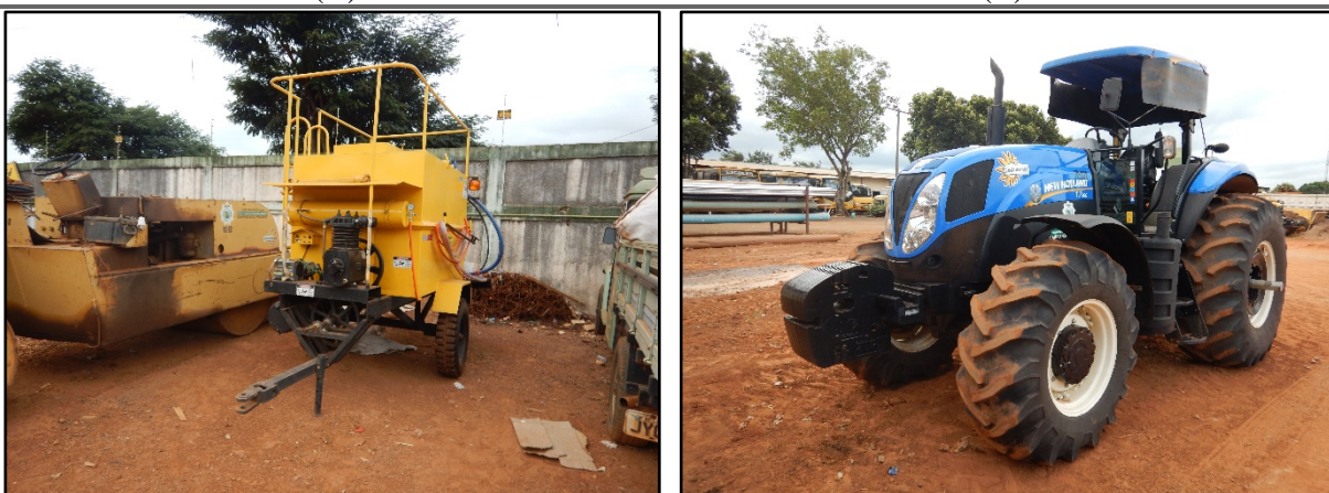
Figura 60. (A) Máquina para pintura de meio fio (B) Trator que auxilia a máquina de pintar meio fio
